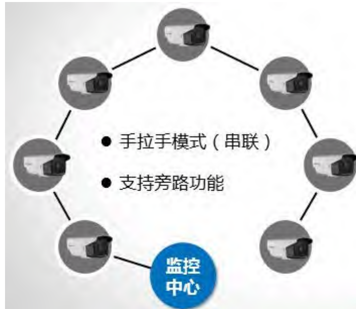
图 59. 手拉手串联摄像机组网
