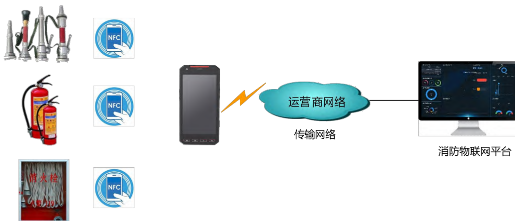
图 90 消防设施巡查系统
