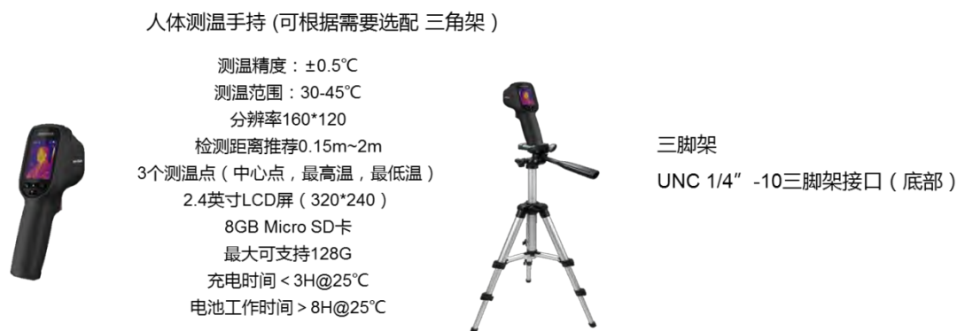
图 81 手持测温安装
