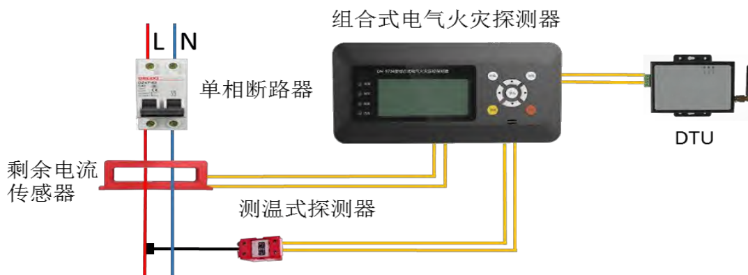
图 51 电气火灾远程监控系统图
