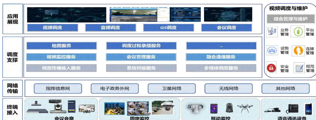
图 173 通信调度系统结构图
